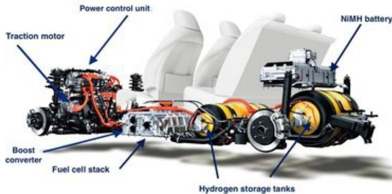
En el Toyota Mirai todo comienza con el hidrógeno, pues al ser recargado el hidrógeno se almacena en los tanques hechos especialmente de fibra de carbono los cuales tienen la capacidad de almacenar 11 libras
